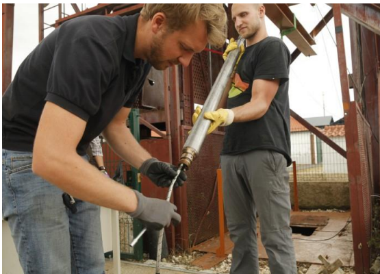
Abb. 2: Wasserprobenahme am 550 m tiefen St-Barbara-Schacht am Uranbergwerk Urgeiriça/Portugal.
