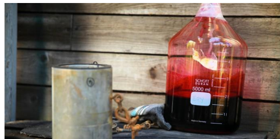
Abb. 3: Eosin-Y-Lösung vor dem Befüllen der Tracer-aufgabesonde LydiA am Bergwerk Metsämonttu/Finnland.
